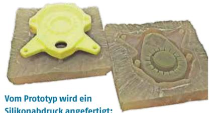
Vom Prototyp wird ein Silikonabdruck angefertigt:
