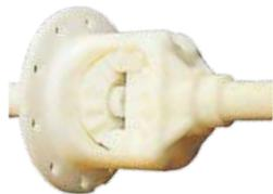
Dieses Kunststoffgetriebe wurde im Schmelzverfahren (FDM) gedruckt.
